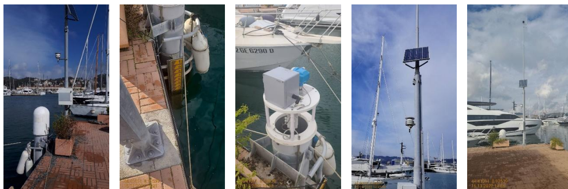
Figura 3.7 – Strumentazione a supporto della stazione di La Spezia. Da destra si riportano la stazione, l'asta idrometrica, l'idrometro galleggiante, il trasduttore di temperatura e l'anemometro ultrasonico
