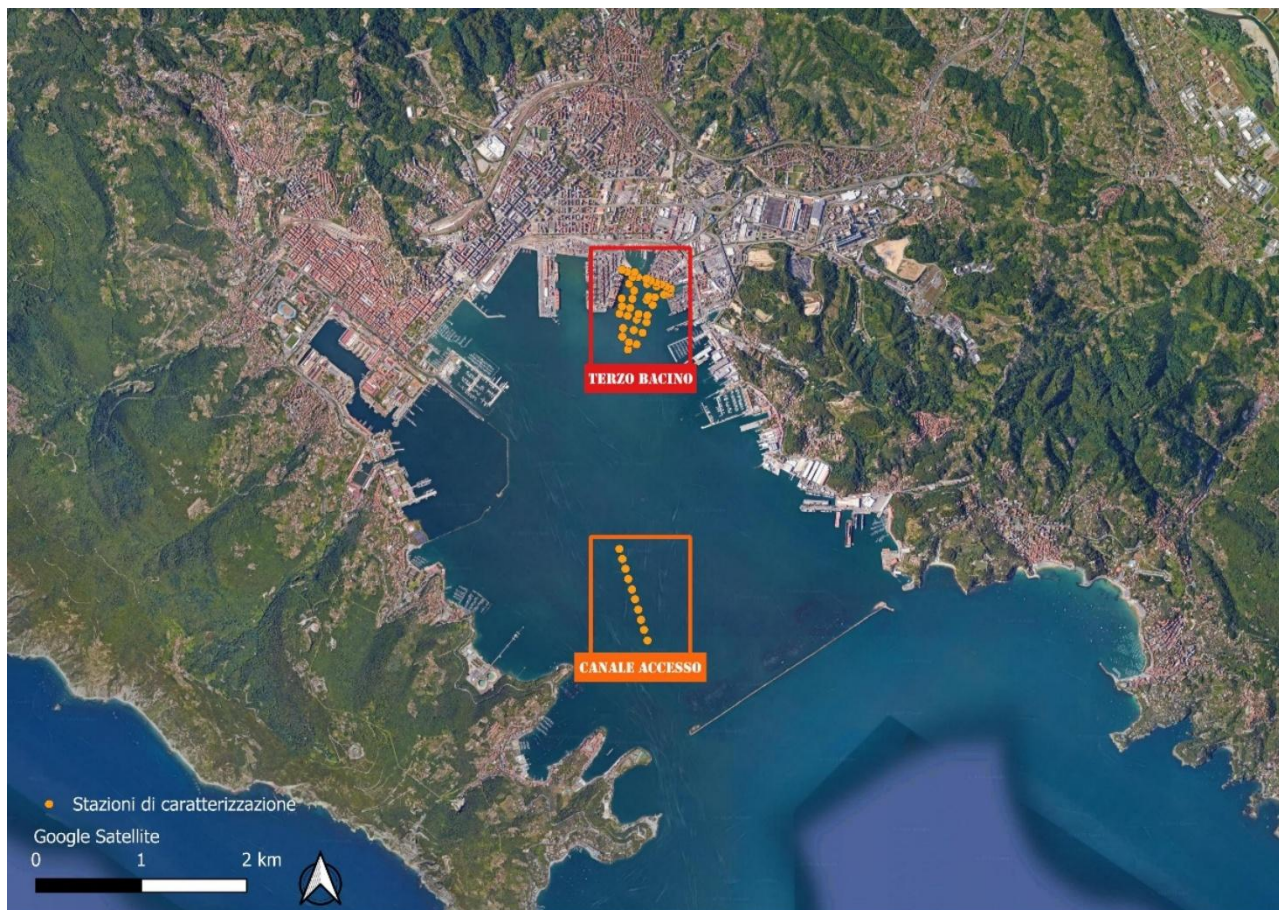
Figura 3-1. Ubicazione delle aree di dragaggio del Terzo Bacino e del Canale di Accesso del porto della Spezia, con indicazione delle stazioni di caratterizzazione ambientale. Si precisa che il Canale di Accesso non è oggetto del presente PMA.
